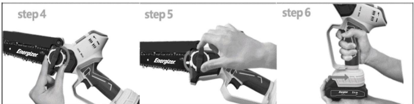
Fixez le couvercle du panneau latéral dans le sens des aiguilles d'une montre, tournez la tension de la chaîne pour régler l'étanchéité de la chaîne.
