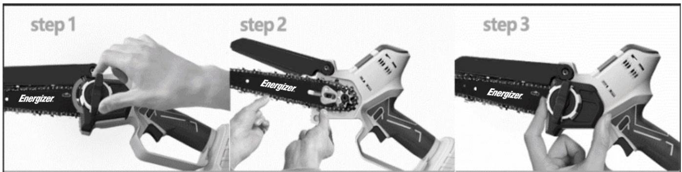
Tournez dans le sens inverse des aiguilles d'une montre le bouton de serrage de la barre et retirez le couvercle du panneau latéral.
